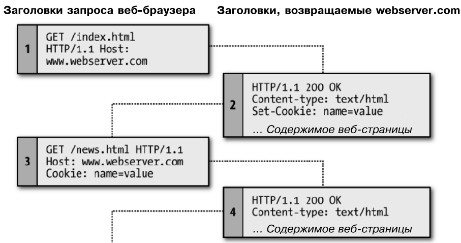
Рис. 13.1. Диалог браузера и сервера в режиме «запрос — ответ» с использованием cookie
