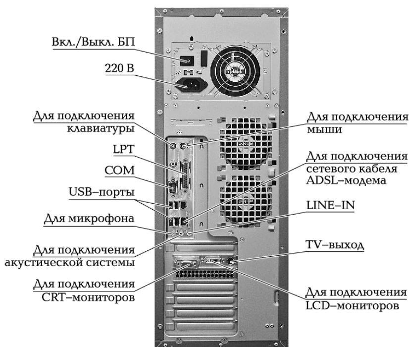
Рис. 1.5. Задняя панель системного блока
